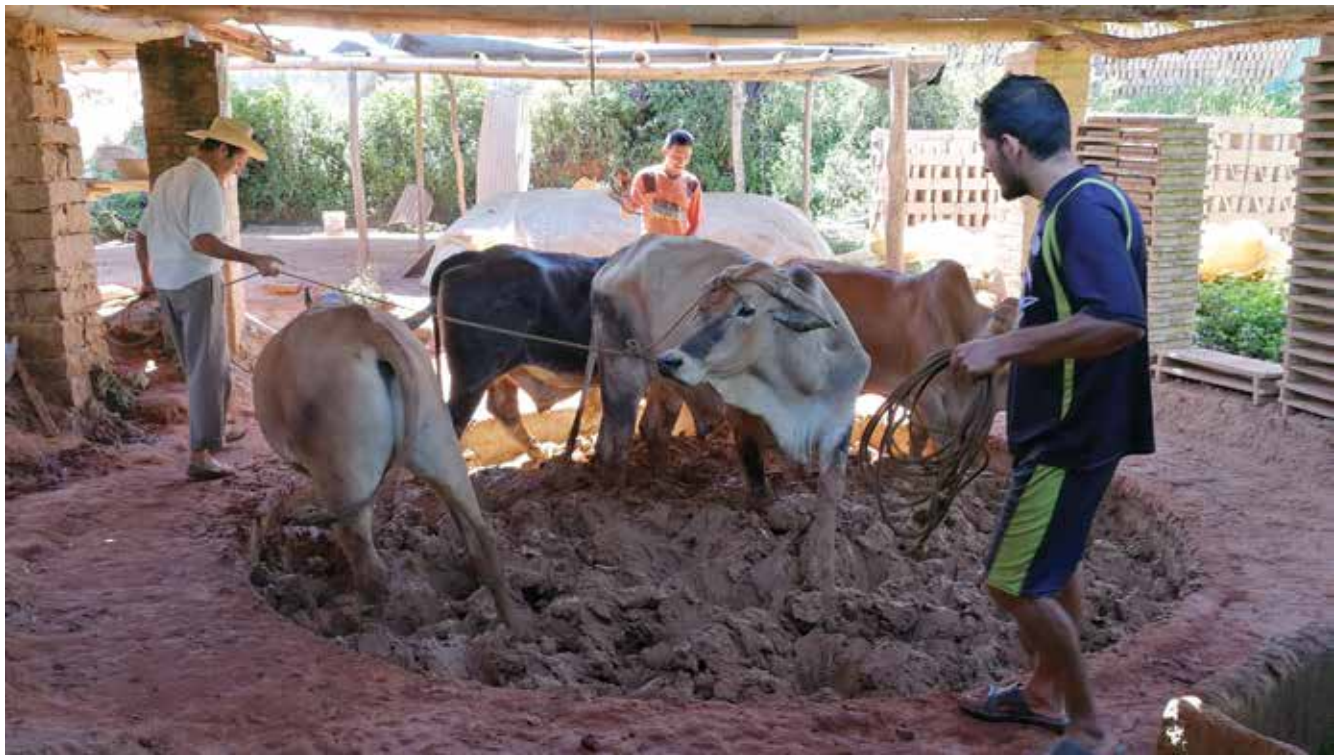
Figura 13. El chircal de la familia Romero, en la vía que conduce de San Gil a Barichara, produce manualmente tejas, ladrillos y tablones de barro cocido. El proceso va desde el amasado a la fabricación de las piezas y el cocido en hornos de carbón.
