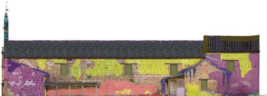
Figure 12. Fotopiano con le patologie di degrado Fonte: Elaborazione grafica degli autori, 2012.
