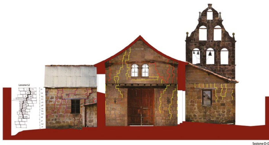
Figure 18. Quadro fessurativo della facciata posteriore Fonte: Elaborazione grafica degli autori, 2012.
