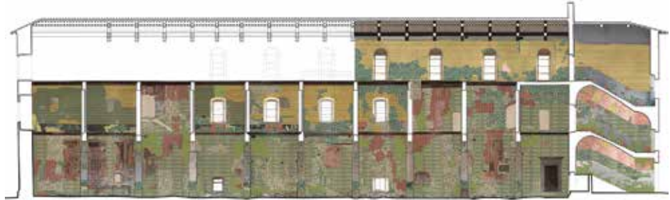
Figura 14. Fotopiano sezione longitudinale su Via del Maglio, con patologie di degrado. Fonte: Elaborazione grafica degli autori, 2017.
