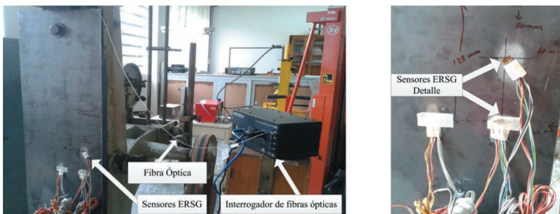
Fig 6. ENSAYO ATRACCIÓN DE UNA LÁMINA METÁLICA INSTRUMENTADA CON SENSORES TIPO FBG Y GALGAS EXTENSIOMÉTRICAS. MONTAJE EXPERIMENTAL (IZQ.), DETALLE DE LA DISPOSICIÓN DE LOS SENSORES ELÉCTRICOS (DER.)
