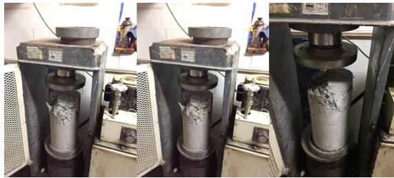
Fig. 3. CILINDROS SOMETIDOS A COMPRESIÓN: A. CON 25% PET; B. CON 50% PET; C. CON 75% PET; D. CON 100% PET
