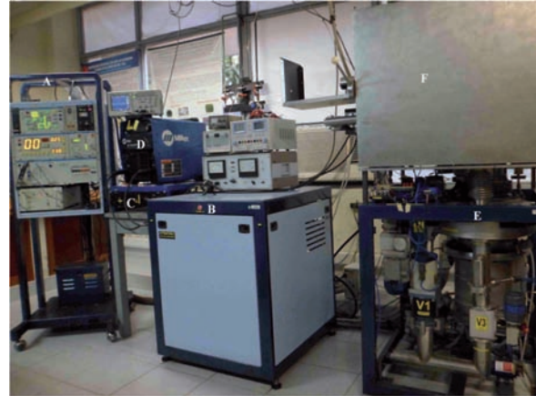
Fig. 1. REACTOR MOSMET. (A) PANEL DE CONTROL GENERAL, (B) FUENTE DE ALTO VOLTAJE, (C) PANEL DE ENCENDIDO DESCARGA DE ARCO, (D) FUENTE PARA EL ARCO ELÉCTRICO, (E) SISTEMA DE VACÍO, (F) CÁMARA DE DESCARGAS
