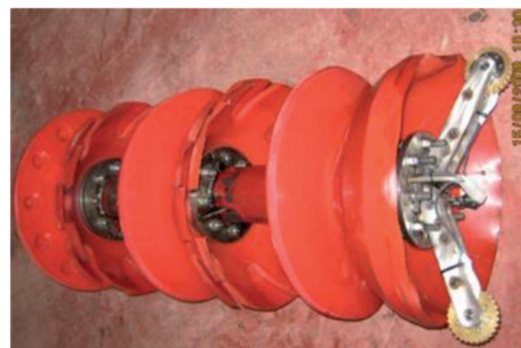
FIG. 9. ESTADO FINAL DE LA HERRAMIENTA EVALUADA EN UN POLIDUCTO DE ECOPETROL
