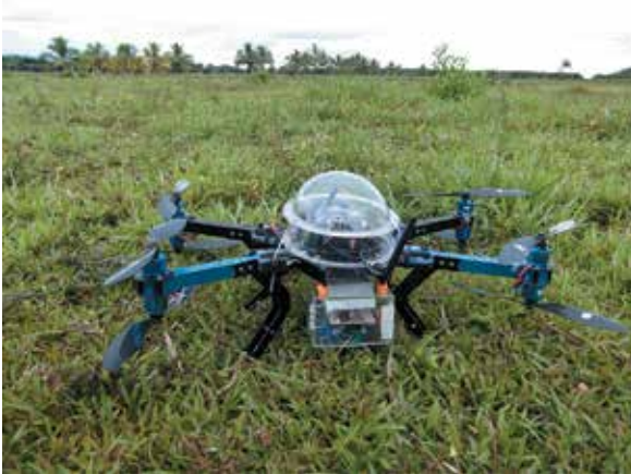
Fig. 10. SISTEMA DE ADQUISICIÓN DE DATOS EN CAMPO PARA LA DETERMINACIÓN DE CARACTERÍSTICAS ESPECTRALES DE LA VEGETACIÓN
