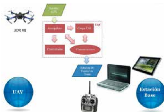
Fig. 9. SISTEMA UTILIZADO PARA LA ADQUISICIÓN DE INFORMACIÓN EN CAMPO PARA EL ESTUDIO DE COBERTURAS DE CULTIVOS
