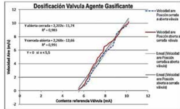
Fig. 13. DOSIFICACIÓN VÁLVULA PROPORCIONAL DEL AGENTE GASIFICANTE
