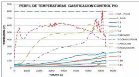
Fig. 17. PERFIL DE TEMPERATURAS (CARBÓN VEGETAL) CONTROL PID
