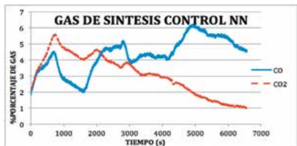
Fig. 20. GAS DE SÍNTESIS (CARBÓN VEGETAL) CONTROL NN
