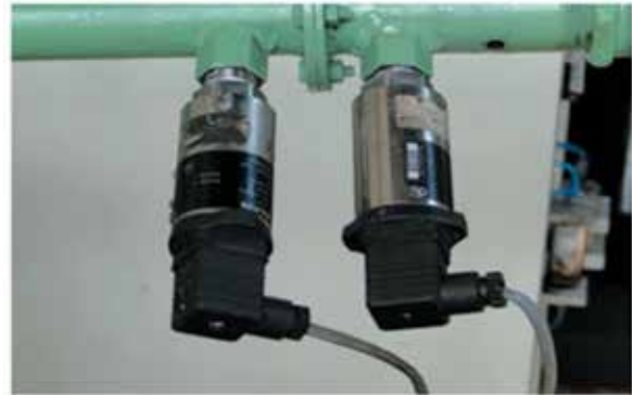
Fig. 5. MEDIDOR DE FLUJO POR DIFERENCIAL DE PRESIÓN Y MEDIDOR DE FLUJO TIPO TAMBOR (RITTER)
