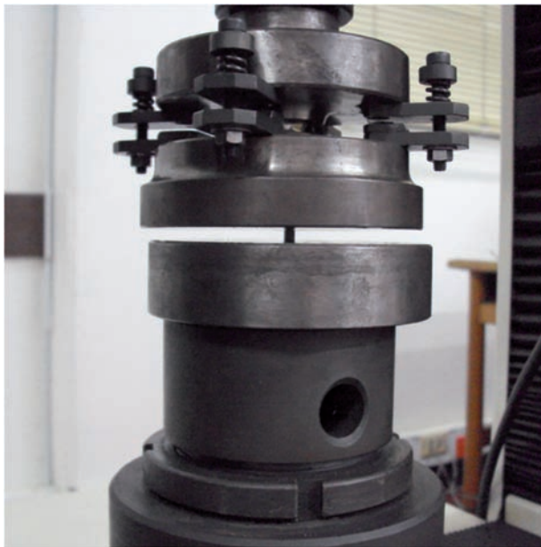
Figura 3. Test de compresión en la máquina universal de ensayos.
