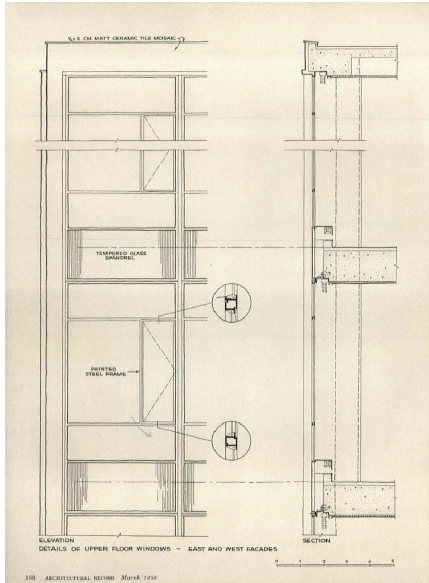
Figura 15. Detalle Spandrelite en fachada. Revista Architectural Record pág. 168. 1958
