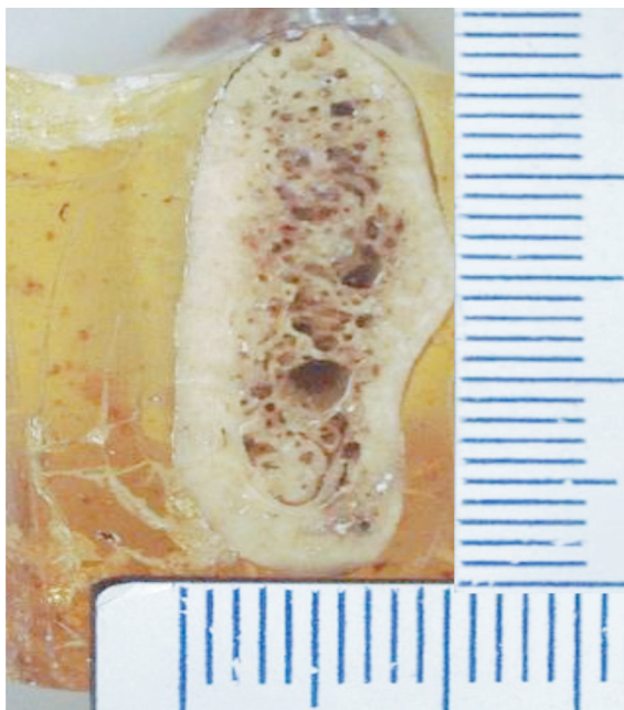
Fig. 2. DIMENSIONES DE LA PROBETA ÓSEA DE LA REGIÓN MOLAR EMBEBIDA EN RESINA POLIÉSTER
