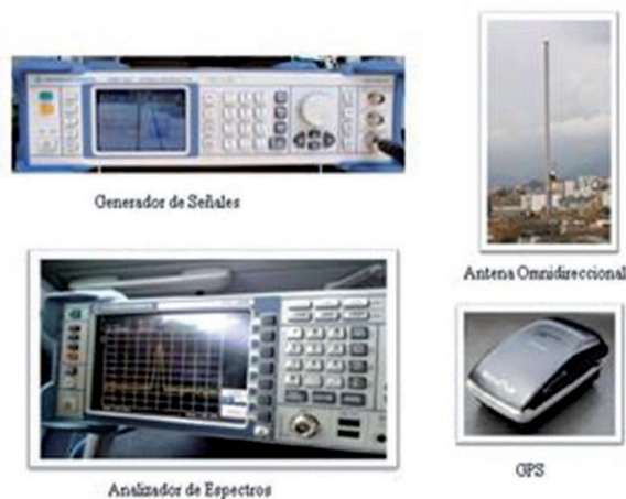
FIG. 5. EQUIPOS DE MEDICIÓN
