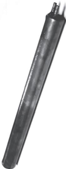
FIG. 5. SENSOR AISLADO CON TEFLÓN
