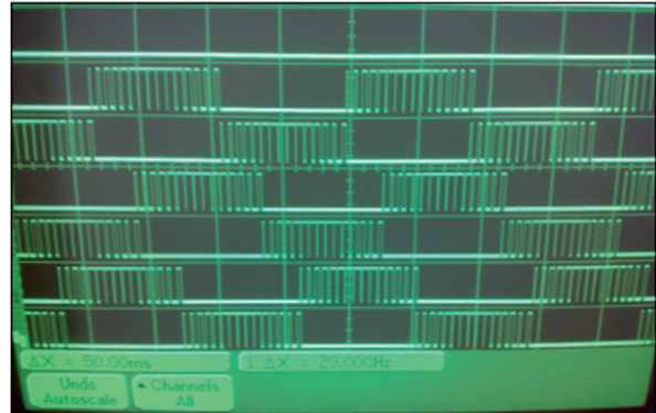
FIG. 12. SEÑALES DE LA MODULACIÓN PWM OPTIMIZADA GENERADAS CON EL DSP PARA UN NP=15.
