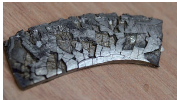
Fig. 2. MUESTRA LAMINADA QUE EXHIBE FRAGILIZACIÓN DEL MATERIAL
