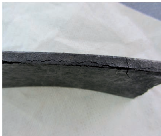
Fig. 1. EN LA MUESTRA RECIBIDA PARA ESTUDIO SE APRECIAN GRIETAS Y DISCONTINUIDAD EN LOS BORDES DE ESTA
