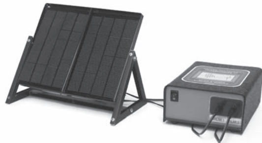
Fig. 16. SISTEMA INALÁMBRICO DE ADQUISICIÓN DE VIBRACIONES
