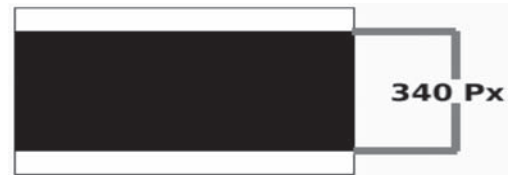
FIG. 4. IMAGEN QUE GENERA UN ERROR DE POSICIÓN CERO EN EL CONTROLADOR DE LA BANDA TRANSPORTADORA
